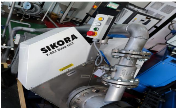
名称：德国西科拉在线测偏仪 用途：监控电力电缆内屏绝缘外屏偏心度
