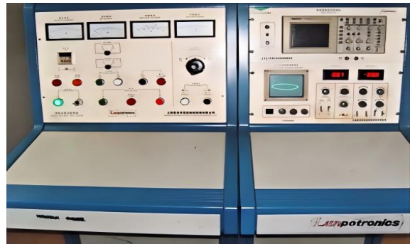
名称：局部放电测试仪-控制台 用途：6-35kV 电力电缆局部放电耐压试验
