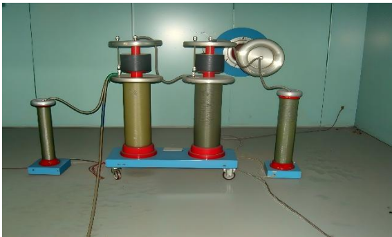
名称：局部放电测试仪 用途：6-35kV 电力电缆局部放电耐压试验
